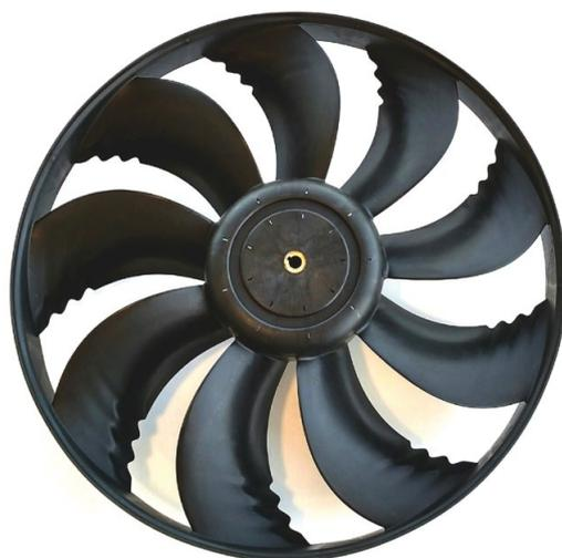
Les 30XB utilisent la technologie de 6<sup>ème</sup> génération de ventilateurs Flying Bird™ de Carrier, conçue pour une efficacité maximale, un niveau sonore très réduit et un domaine de fonctionnement étendu. Le ventilateur inclut la technologie brevetée par Carrier de carénage tournant et des pales à balayage arrière avec un bord de fuite dentelé unique inspiré de la nature.
