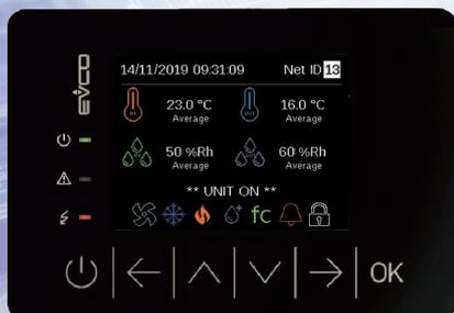
Le microprocesseur de contrôle Survey<sup>3</sup> a été conçu pour une gestion simple et intuitive et une surveillance en temps réel de tous les cycles de fonctionnement des unités grâce au grand écran couleur (320 x 240 pixels) et aux touches tactiles.
